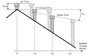
Рис. 1 Размещение дымохода относительно конька крыши
